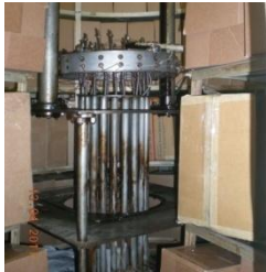
Рис.8. Гамма-пушка К-20000, используемая для облучения биологических образцов (НИИ ядерной физики СПбГПУ)
