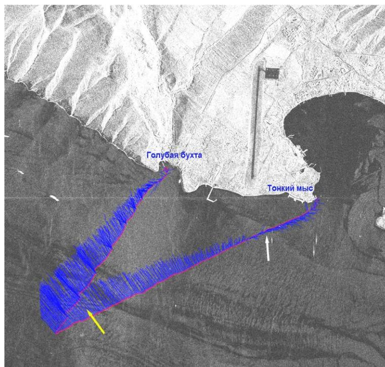
**Рис. 4.4.1.2.** Фрагмент РЛИ TerraSAR-X от 16.09.2012. Синим цветом отмечены скорость и направление течения по данным ADCP в период спутниковой съёмки. Жёлтая стрелка указывает на положение поверхностных проявлений внутренних волн, выявленных с помощью ADCP. Белая стрелка указывает на слик, расположенный в области смены направления течения
