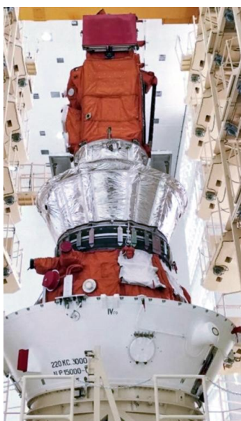
Рис. Внешний вид блока выведения с приборами БОКЗ-М60 и установленным на нем МКА «Ломоносов» и «Аист-2Д»
