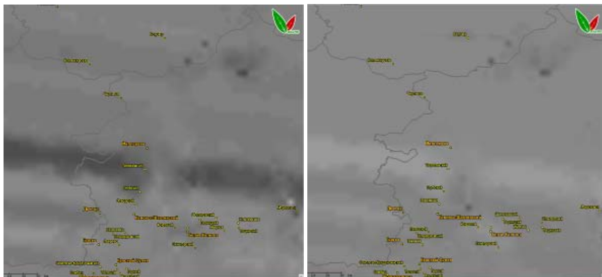
Рисунок 2.2.3 — Изображения локализованных смещений изображения КМСС (красный канал) от 13.08.2018 по горизонтальной ( слева ) и вертикальной ( справа ) координате, выявленных после комплексной допривязки изображения; хорошо заметны линии аномалий локальной привязки, идущие поперёк направления полёта спутника
