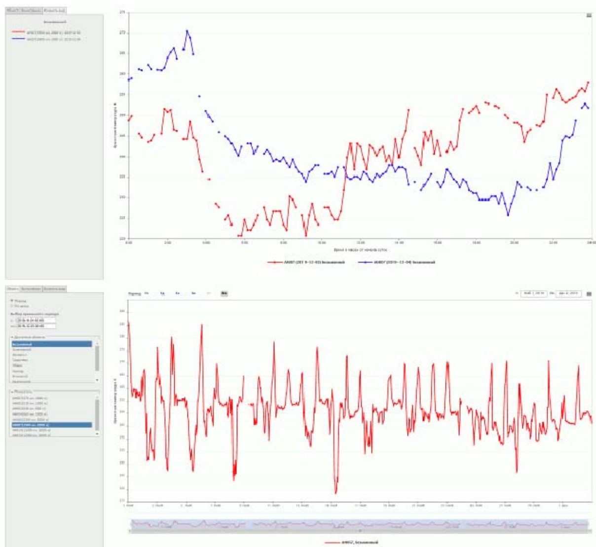
Рисунок 3.2.1.1.1 — Анализ временной динамики радиояркой температуры вулкана Безымянный: сравнение суточной динамики в разные дни ( вверху ) и обзор динамики за месяц ( внизу )
