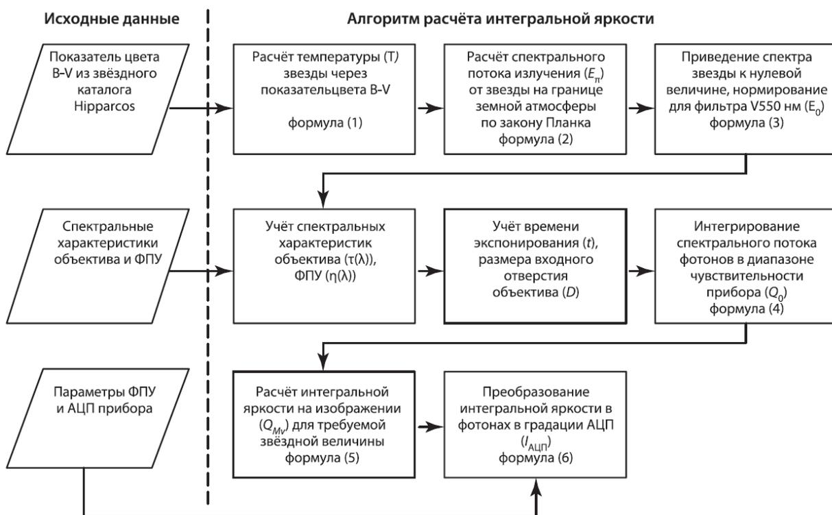
Рисунок 1.4 – Исходные данные и алгоритм расчёта интегральной яркости звёзд
