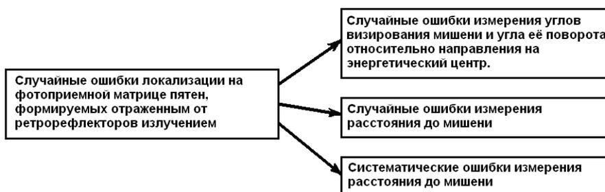
Рисунок 1.16 - Ошибки измерений координат мишени
