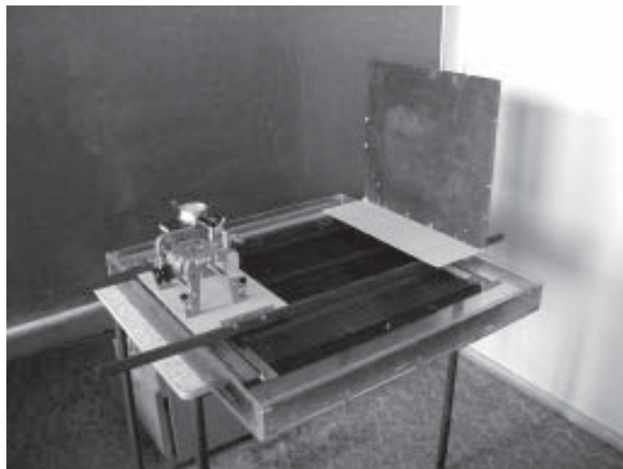
Рис. 10. Внешний вид установки для определения профиля исследуемой поверхности
