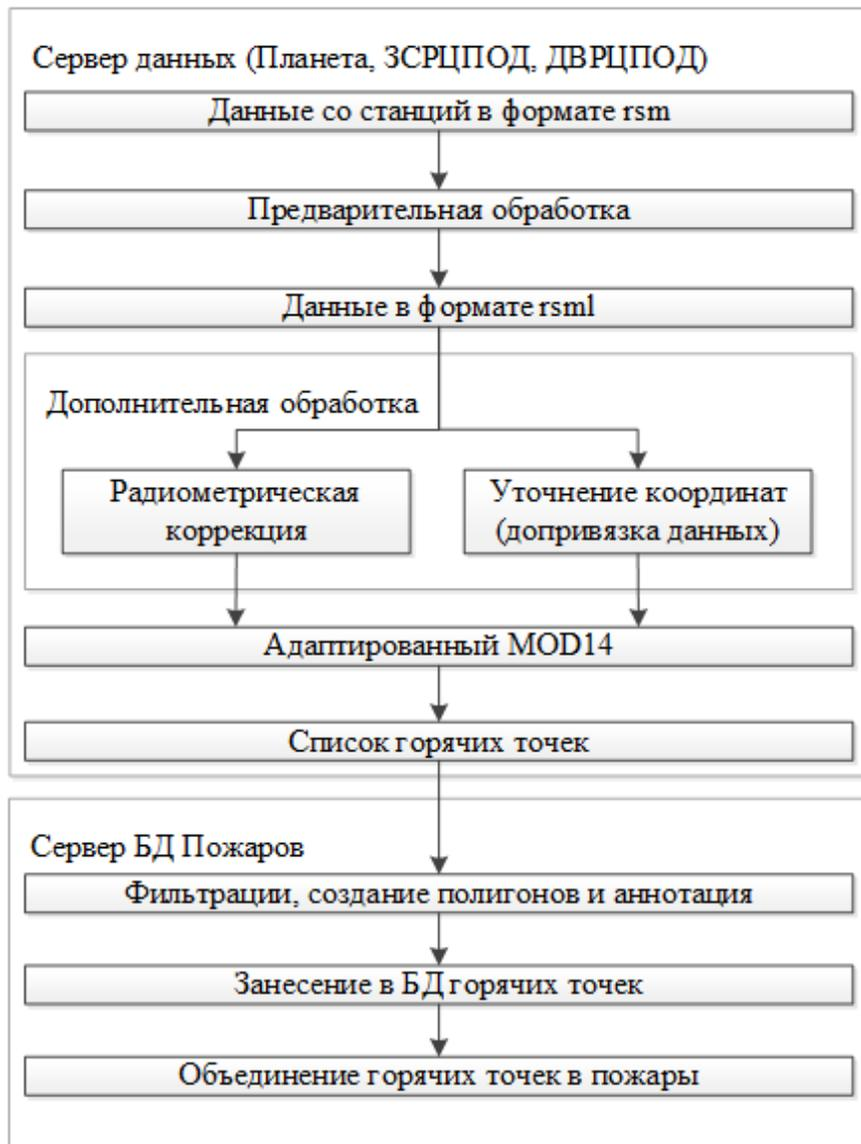
Рисунок 4.16 - Схема технологии обработки данных МСУ-МР
