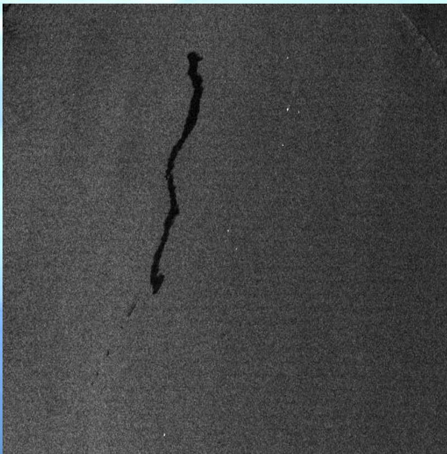
Фрагмент ASAR Envisat изображения, полученного 12 августа 2006 г. Площадь нефтяного пятна 29,8 кв.км
