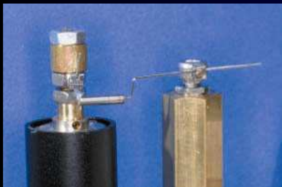
Рис.9. Ортодонтический аппарат, с которого снимаются данные нагрузка-перемещение
