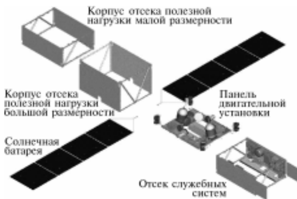
Рис.1. Модульный принцип построения космического аппарата на базе УКП «Виктория»
