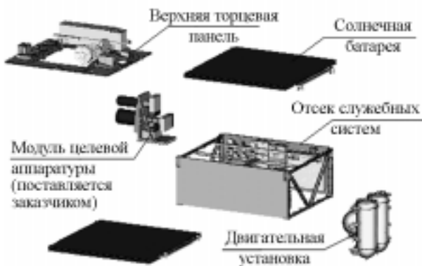
Рис. 5. Модульный принцип построения космического аппарата
